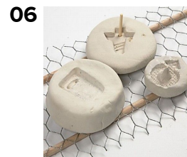
TÄRKEÄÄ!! □ Ennen tinan valamista, saveen PITÄÄ olla täysin kuiva. Jos kaadat sulaa tinaa kosteaan muottiin, voi tina alkaa roiskimaan. Laita noin 2 cm paksuinen muotti ritilälle kuivumaan 3-4 päiväksi. □
