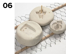
TÄRKEÄÄ!! □ Ennen tinan valamista, saveen PITÄÄ olla täysin kuiva. Jos kaadat sulaa tinaa kosteaan muottiin, voi tina alkaa roiskimaan. Laita noin 2 cm paksuinen muotti ritilälle kuivumaan 3-4 päiväksi. □
